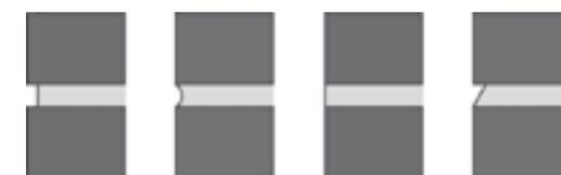
RAKED JOINT    IRONED JOINT    FLUSH JOINT    STRUCK JOINT
